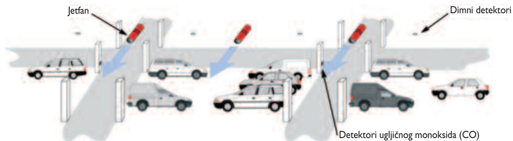
Slika 2. Primjer sustava impulsne ventilacije
